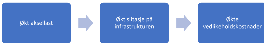
Figur 5 Sammenhengen mellom aksellast og vedlikeholdskostnader
