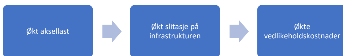
Figur 5 Sammenhengen mellom aksellast og vedlikeholdskostnader
