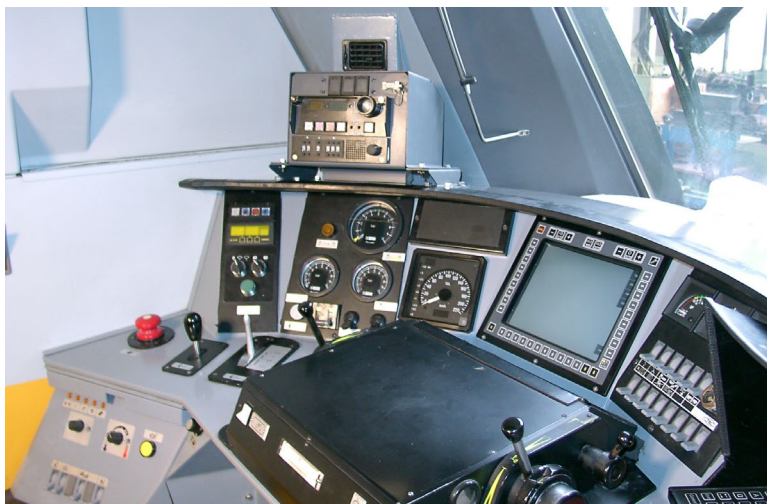
Figur 2: ERTMS-førerpanel i tog
